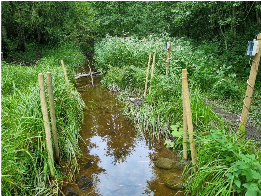
Figur 6: Retningsbestemt antenne fra Stiklestad skole. Her ser man den kobbertråden langs med bekkebunn som danner ett elektrisk felt der PIT-merkene blir aktiverte.
