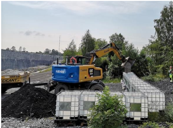
Figur 33- Utendørs kontainerforsøk på Langøya med de samme materialene som inngår i kolonneforsøket.
