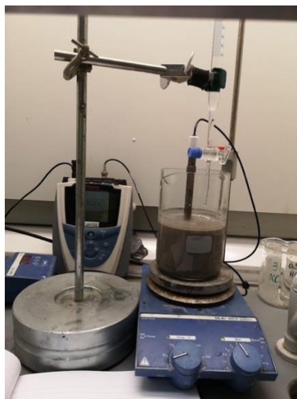
Figur 5- Oppsett av titreringsforsøk. Betongløsningen i begerglass står på en magnetrører, og røres kontinuerlig. 1M syre tilføres dråpevis med hjelp av en byrette festet til et stativ. pH måles i sanntid.
