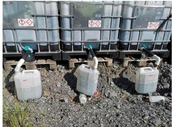
Figur 33- Utendørs kontainerforsøk på Langøya med de samme materialene som inngår i kolonneforsøket.
