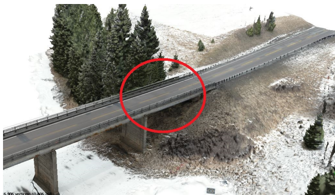
Figur 4.16: Område hvor modellen har blitt mangelfull. Dette gjelder også på andre siden av brua.
