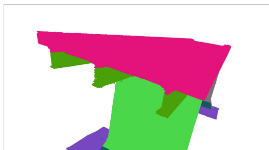
(a) De øverste delene av H-bjelkene ligger i samme segment som brudekke.
