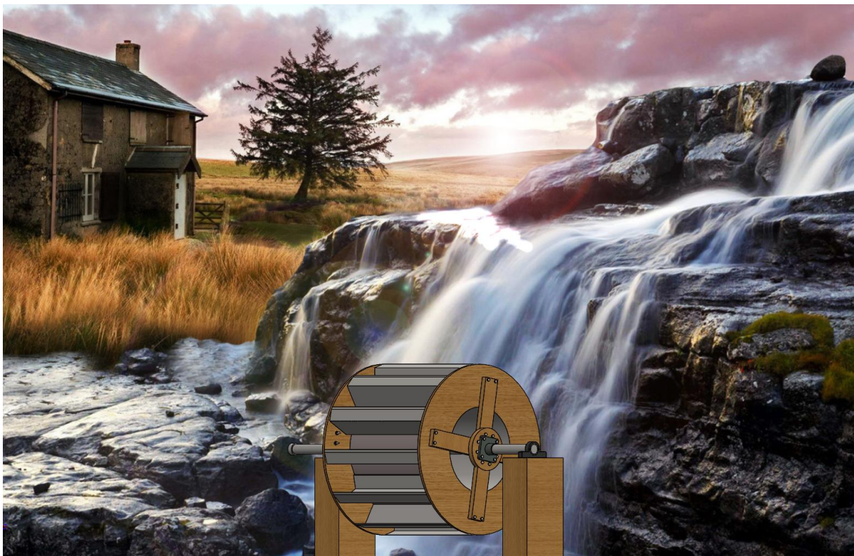
Figur 14.5: Konseptløsningen er plassert ved et gjorde og kan supplere strøm til tomten. I denne situasjonen vil det behøves en renne eller rør.
