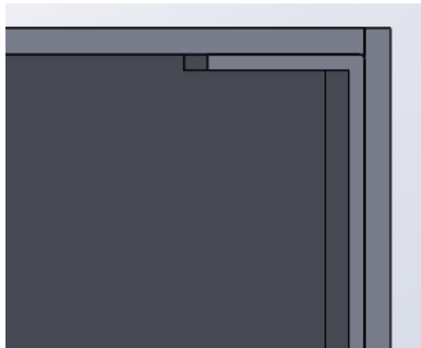
Figur 11.19: Viser hvordan profil type 1 er plassert i forhold til sideplatene Den blir montert på tilsvarende vis som profil type 2.
