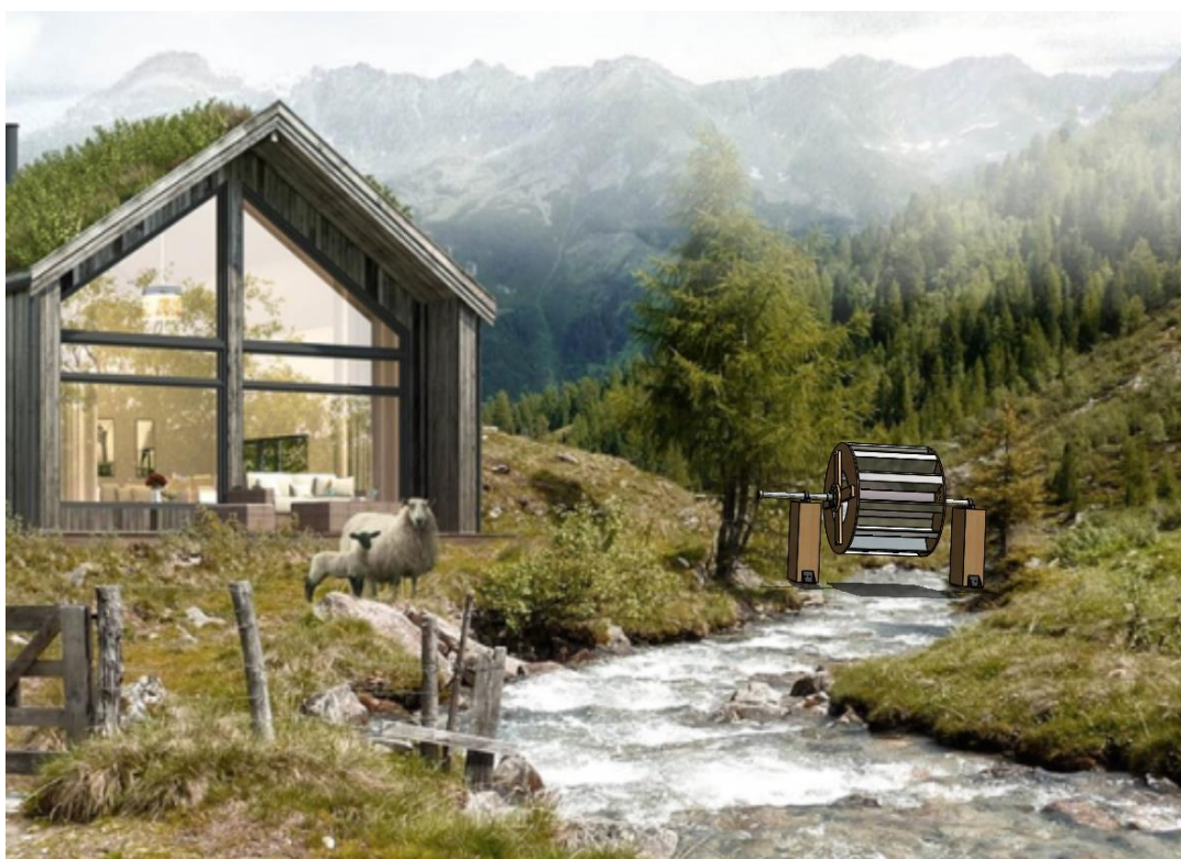
Figur 14.1: Vannhjulet er plassert ved en elv ved ett fritidsbolig. For denne løsningen vil det behøves å tilpasse elevstrømningen og gjøres utbyggelsler. Generatoren er ikke tatt med i bilde, og må forestilles å være på siden i en bebyggelse.
