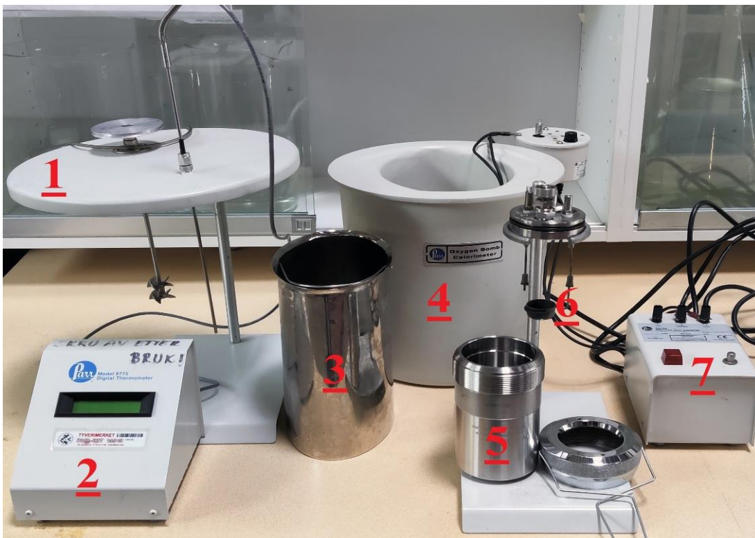
Figur 3-1: Kalorimetrioppsettet der komponentene er; 1, Lokk med røremekanisme og termometer; 2, Digital termometer; 3, Vannbøtte; 4, Isolert beholder; 5, bombe; 6, stativ med kapsel og tenntråd-feste; 7, antenningsenhet. Komponent 1 og 4 sørger for tilstrekkelig isolasjon av systemet i kalorimeteret. Vannbøtten fylles med vann fra springen og denne veies på en vekt fra Soehnle (modell 67080) med oppløsning på 1 g. Det ble brukt ca. 2000 g vann i alle forsøkene. Prøvene legges i skålen vist i 6 og tenntråd festes på elektrodene. Deretter legges denne i bomben som fylles deretter med oksyngengass opptil et trykk på ca. 25 bar i alle forsøk. Bomben plasseres i vannbøtten som igjen legges i kalorimeteret. Prøven antennes og temperaturøkningen i vannbøtte sammen med tiden noteres ned fra termometeret.
