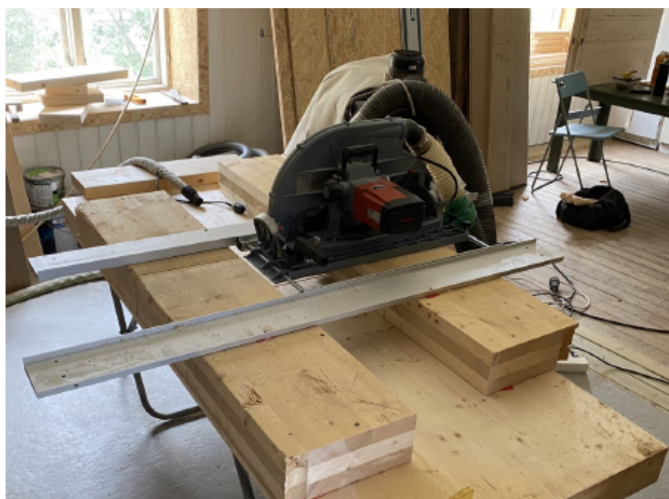
Figur 3-6. Vinkelrett sagejigg for kapping av lengder før videre formatering av blokkene. Avstandsklosser ble brukt til å sette riktige lengder.
