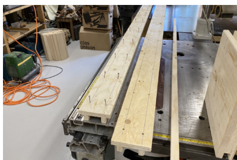
Figur 3-13. Topp- og bunnsvill under montering. Løse fjærer av kryssfiner ble skrudd fast i en 120 mm bred kryssfinerplate.
