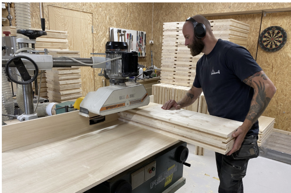
Figur 3-8. Sinksporet freses ut på enden av blokkene. Avbildet: Frode Anker Røsstad.
