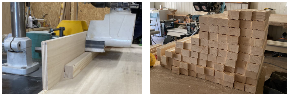
Figur 3-11. Fresing av doble skyvesinker (venstre). Ferdig formaterte doble skyvesinker (høyre).
