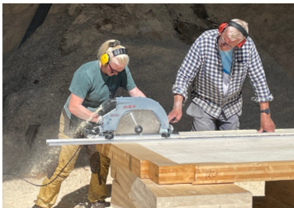
Figur 3-5. Tilskjæring. KL-tre restmaterialer blir sagt i strimler med bredde på 300 mm. Avbildet: Johanne Kolstad (venstre) og Ivar Ragnhildstvedt (høyre).
