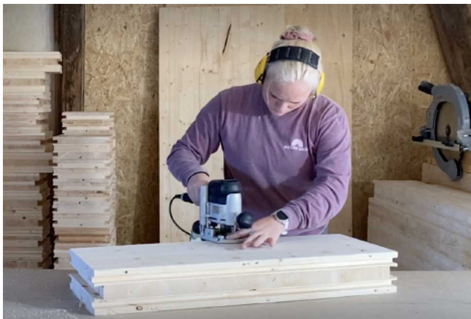
Figur 3-9. Kantfresing med en Festool OF1010 overhåndsfres med et 45° fresestål. Avbildet: Johanne Kolstad.
