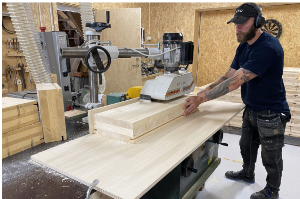
Figur 3-7. Fres med automatisk innmatingsanlegg ble brukt til å produsere notsporene i blokkene. Avbildet: Frode Anker Røsstad.
