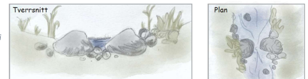
Figur 76. Prinsipp som viser tersklene i Melbybekken. Illustrasjonen er basert på Norconsult (2015).
