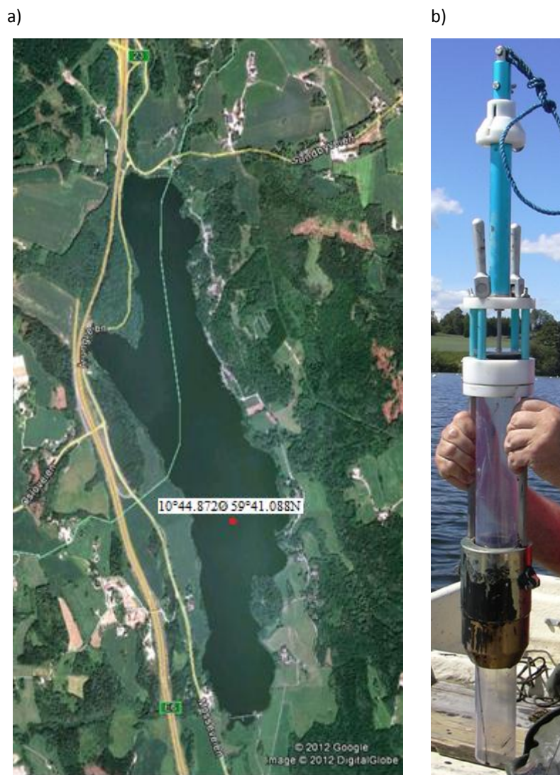
Figur 6: a) Innsamling av sedimentkjerner i Årungens akkumuleringssone ved 13,28 meter. Uttakspunktet, lokalisert ved 10°44.8720' 59°41.088'N, er merket rødt (Google Earth Inc. 2012). b) Sedimenthenter, Uwitec Gravity Corer, med transparent PVC-rør og en 4 kilos vekt ble brukt under innsamling av sedimentkjerner i Årungen den 6. juli 2010 (foto: Turid Snuggerud).
