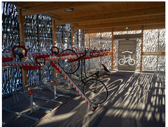
Figur 59: Sykkelhotellet ved Kolsås stasjon innendørs. Hotellet har to-etasjes parkering og A-stativer.
