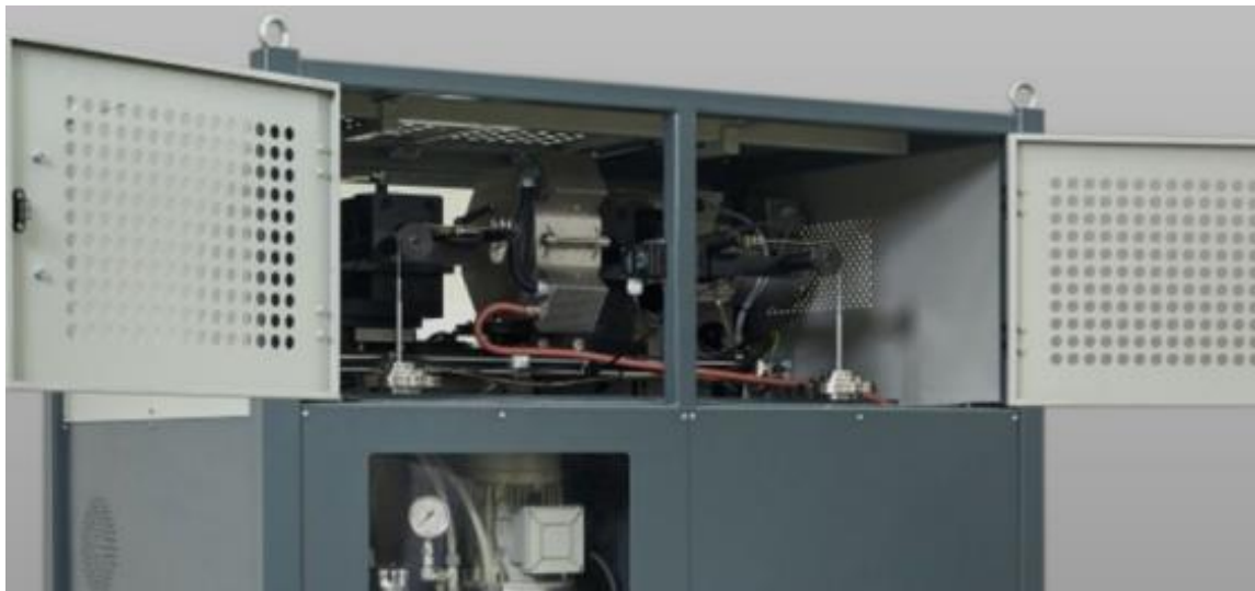
Figur 4.18. Bilde fra bakside av maskin der vektarmene og trinser på høyre og venstre side er synlige.
