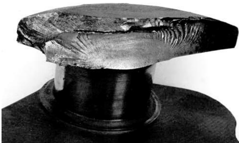
Figur 1.4. Utmattingsbrudd i veivaksel. Bildet viser tydelige striasjoner som er resultat av vekslende belastning og sprekkvekst [5].
