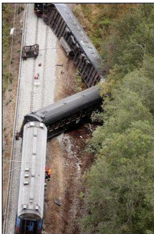
Figur 1.2. Ulykke forårsaket av utmattingsbrudd i toghjul [3].
