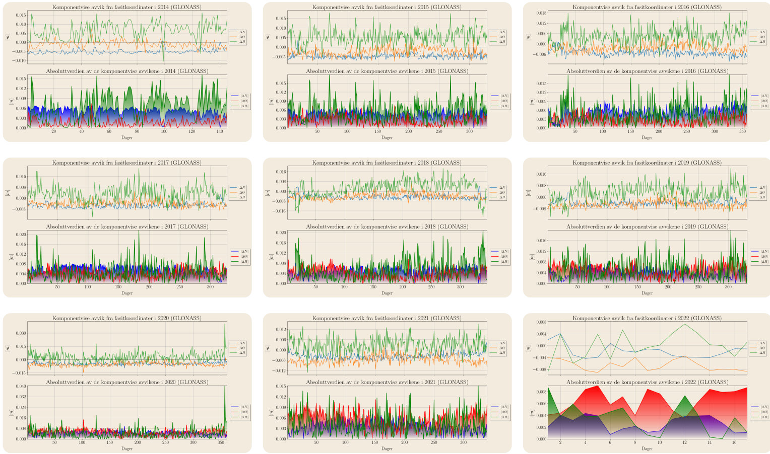
Fig. B.2: Komponentvise avvik fra fastkoordinatene til OPEC, og de respektive absoluttverdiene for hele tidsserien (GLONASS).
