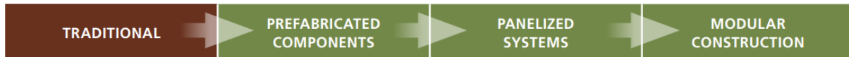
Figur 4. Figuren viser spekteret fra tradisjonell byggemetode hvor all produksjon gjøres på byggeplass, til modulbasert konstruksjon hvor mesteparten av produksjonen gjøres på fabrikk. WoodWorks. (2014). "Traditional to Modular Construction – a Continuum". Prefabricated and Modular Construction , s. 3. Tilgjengelig fra: https://www.woodworks.org/wp-content/uploads/prefab-modular_case_study.pdf (lest 18.04.2022)
