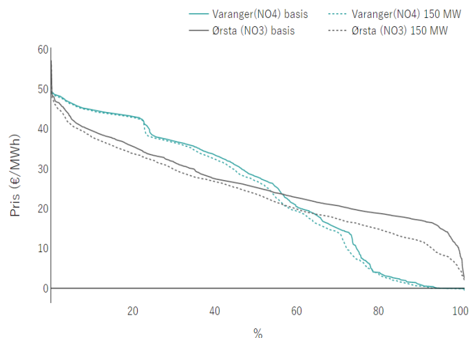
Figur 6-12: Varighetskurver for pris i Varanger (NO4) og Ørsta (NO3) før og etter tilknytning av ny vindkraft.
