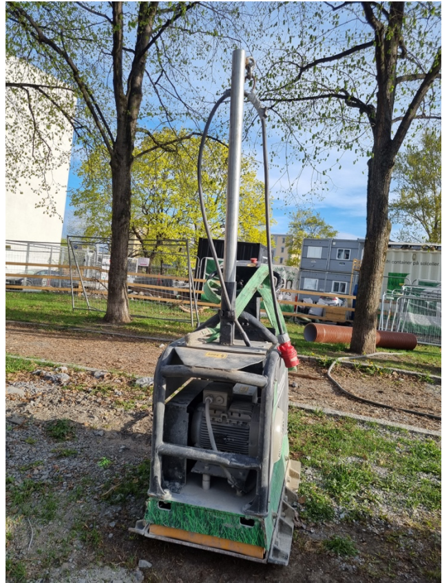
Bilde 1: Selvutviklet elektrisk vibroplate (Dahl, 2022).
