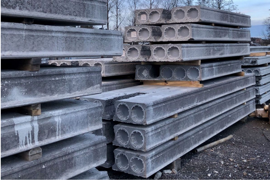
Figur 5: (Bygg.no, 2020), Brukte hulldekkere
