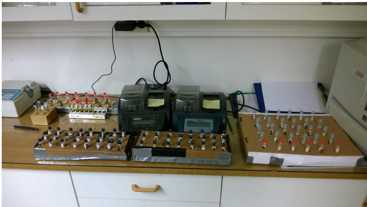
Figur 13: Reagenser benyttet til måling av Tot-P, Orto-P og KOF. To varmeblokker av typen Hach-Lange LT 200 i midten av bilde.
