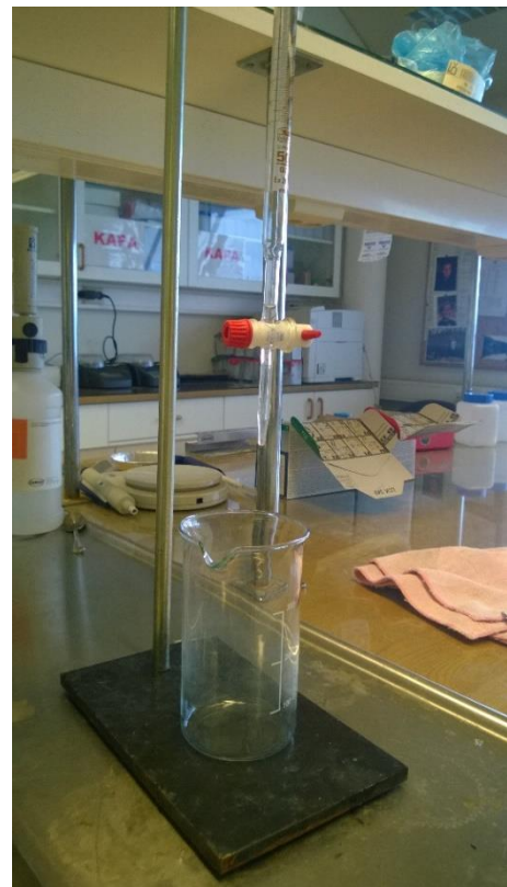
Figur 15: Titreringsoppsett benyttet til beregning av prøvenes alkalitet.
