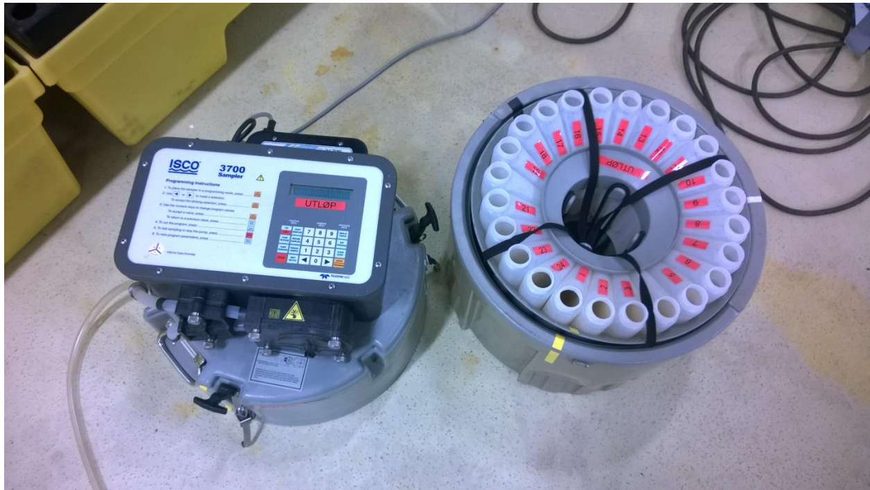
Figur 6: Rulettprøvetakere av typen Teledyne ISCO 3700 ble benyttet til innhenting av prøver.
