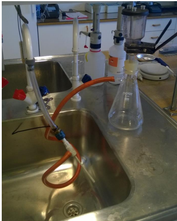
Figur 14: Filteroppsett benyttet til filtrering av prøvene.
