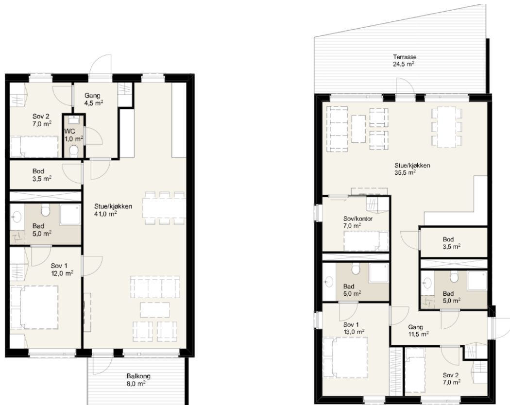
Figur 5 og 6: Planløsningen til venstre er en 3-romsleilighet på 76 m 2 som henvender mot en bred svalgang som har utsikt til den tropiske vinterhagen. Leiligheten til høyre er en 4-romsleilighet på 90 m 2 som ligger på bakkeplan utenfor fellesbygget med vinterhagen (Signaturhagen, 2020).
