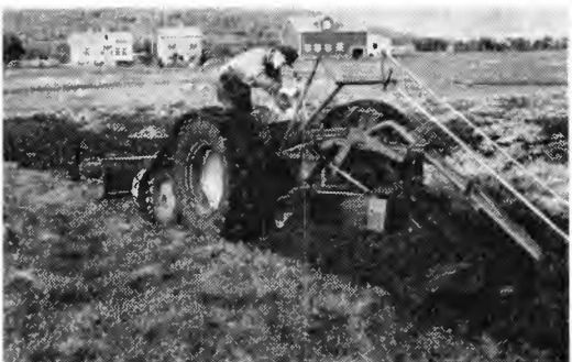
Trench Hog gravekjedemaskin prøvd bl. a. på Dalstad, Hadsel.
