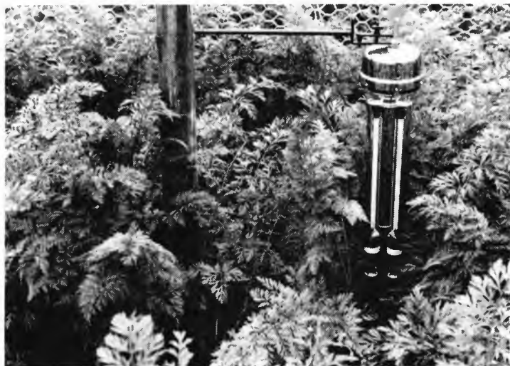
Måling med Assmanns aspirasjonspsykrometer.
