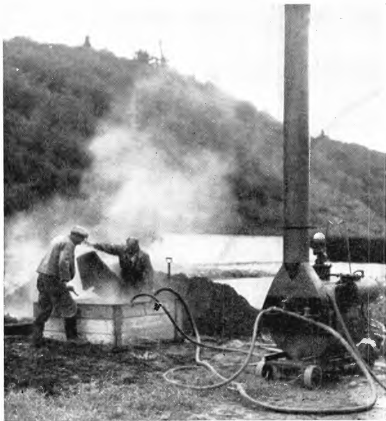
Foto 1 a. Tiltrekkingsjord blir dampet i kasse på Kvithamar ved hjelp av en 5.5 m 2 Bassøe lavtrykkskjel. (Fot. forf.)
