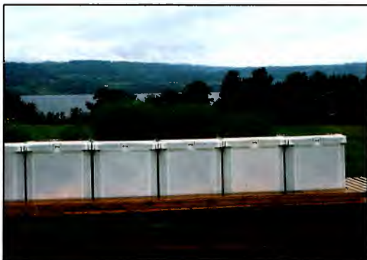
Kornforsøk med kalket VEAS-slam 1990. Ca. 700 l jord/slam pr. kasse. Pernilla bygg, ugjødslet. Fra venstre: 160 kg slam (60 t slamts./daa). 13 kg slam (5 t slamts./daa). 8 kg slam (3 t slamts./daa). 3 kg slam (1 t slamts./daa). 0 kg slam.
