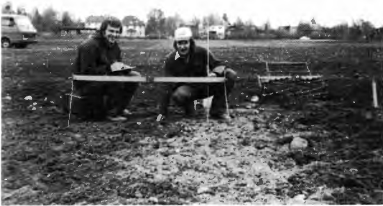
Fig. 6. Måling av ujamnhetene på overflaten og bunnen med relieffmeter. Measuring the roughness of the tillage surface and the pan with reliefmeter.
