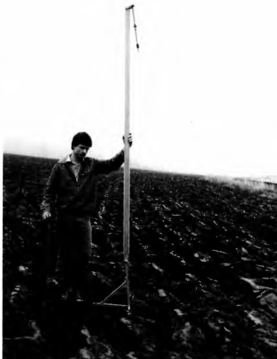
Fig: 15. Relieffmeteret som kunne svinges opp og senkes tilbake i utgangsstillingen.
