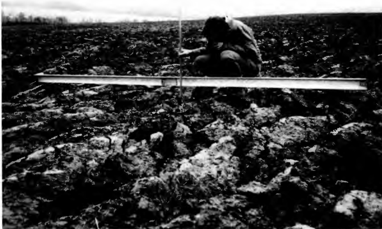
Fig. 7. Lang bjelke for måling av ujamnheten på overflaten. Long beam for measuring the roughness of the surface.
