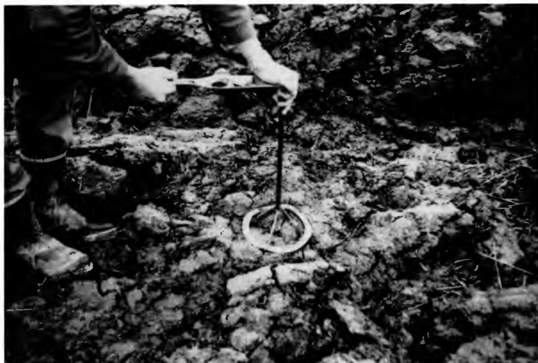
Fig. 4. Måling av jordas skjærfasthet med vingebor. Measuring the shearing strength of the soil with shear vane.
