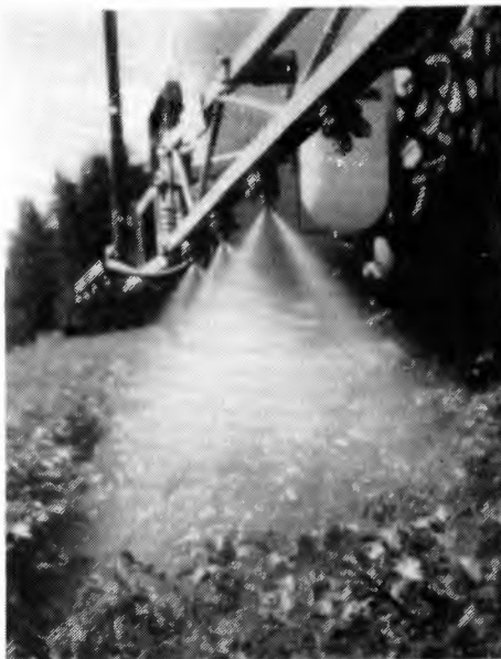
Figur 36 Akersprøyte med flat- dyser med tostrålet væskedusj, 1983.
