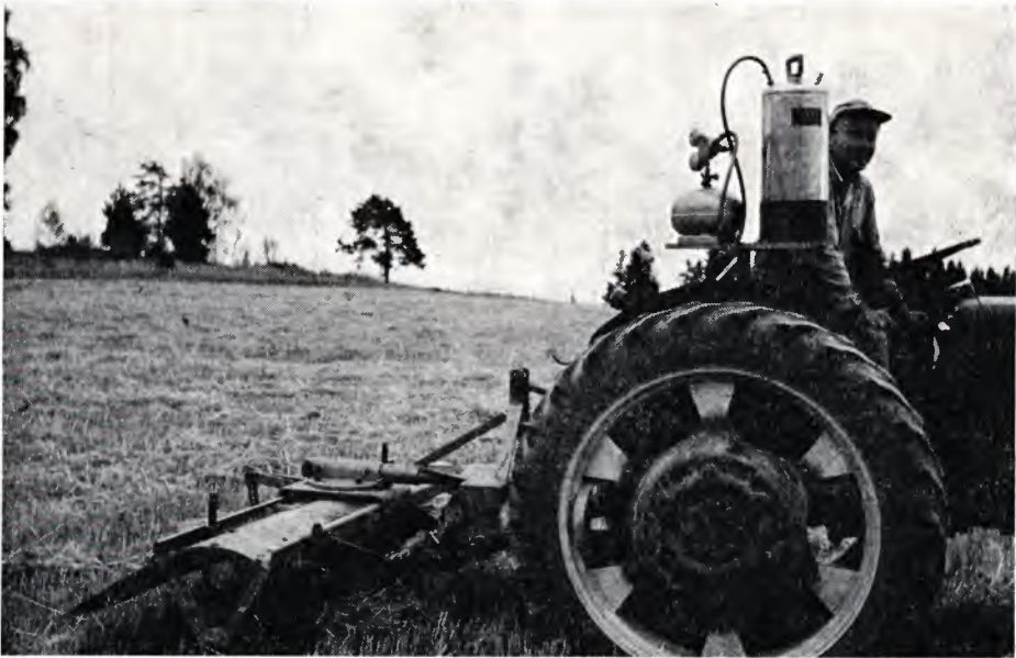
Fig. 1. Forsøksutstyret i arbeide. Sprøytebommen ble festet foran fresevalsen på ei Gehring rotorharv slik at sprøytedusjen kunne rettes inn i valsen eller rett ned mot bakken. Væsketank og trykkilde ble festet på traktoren. Foto: A. Nordby.
