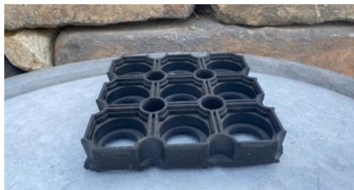
Figur 13: Prøve av gressarmering. Foto: Helene Hofmann
