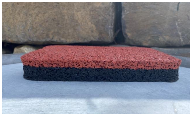
Figur 3: Tversnitt av plass-støpt gummi. Foto: Helene Hofmann
