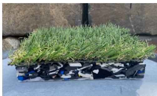
Figur 14: Prøve av kunstgress med støtdempende underlag av skumplast. Foto: Helene Hofmann
