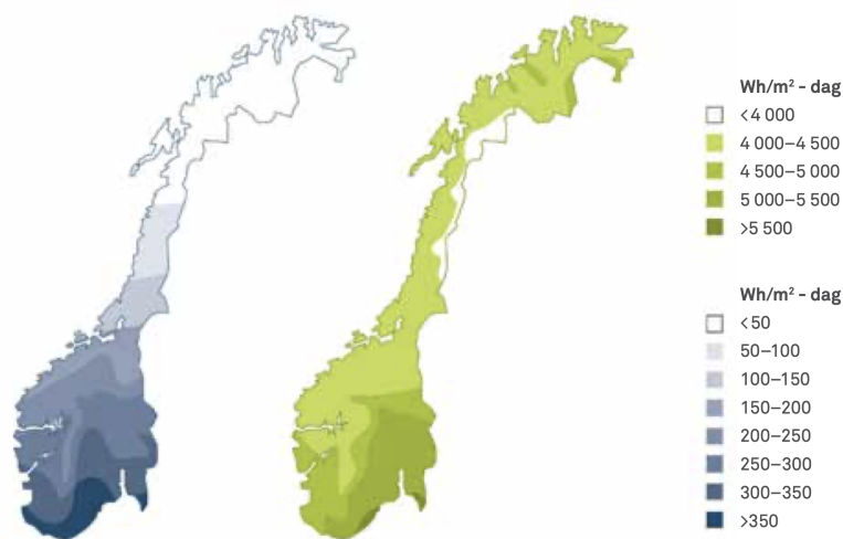
Figur 2.5: Innstrålt energi per kvadratmeter i Norge på horisontalen i henholdsvis januar og juli for et normalår. Illustrasjonen er hentet fra [31].
