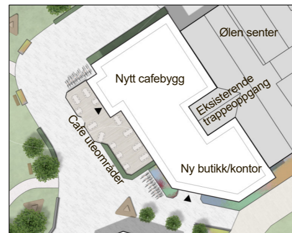
Cafeen er konstruert som et påbygg, men har ikke gjennomgående inngang til Ølen senter. Eksisterende trappeoppgang i Ølen senter er beholdt.
