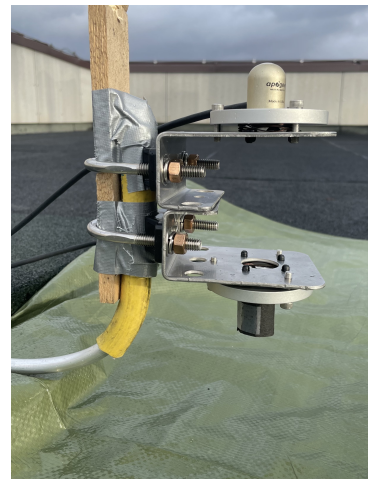
(c) Nedovervendt pyranometer pekende mot flaten som skal undersøkes.
