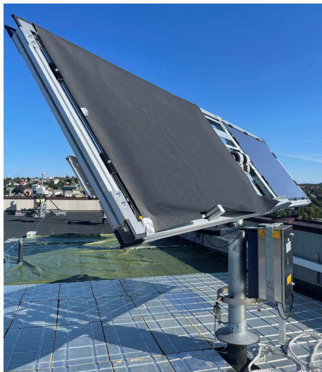
Figur 3.4: En utskjært takpapplate tapet fast på fremsiden av MS03 under forsøk utført med oppsett 1. Her har PV 3 takplater med aluminiumsoverflate på området rundt stativfoten.
