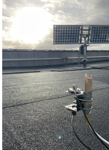
(b) Pyranometeroppsett og solens posisjon under målingene.
