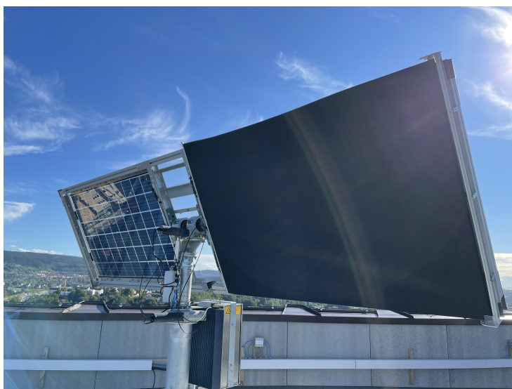
Figur 3.5: Svart rullegardin montert på en PV-modul under forsøk utført med oppsett 2.
