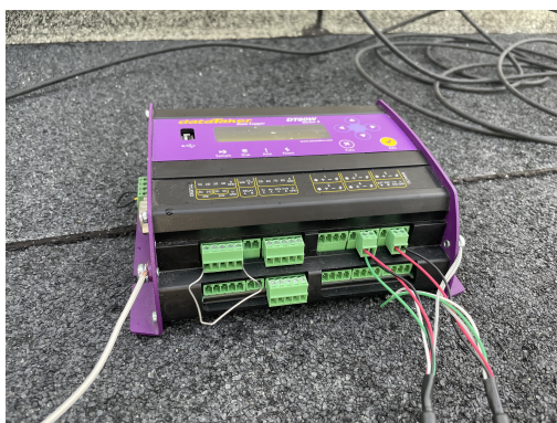
Figur 3.8: Data Logger DT80W tilkoblet to pyranometere for logging av innstrålingsdata.
