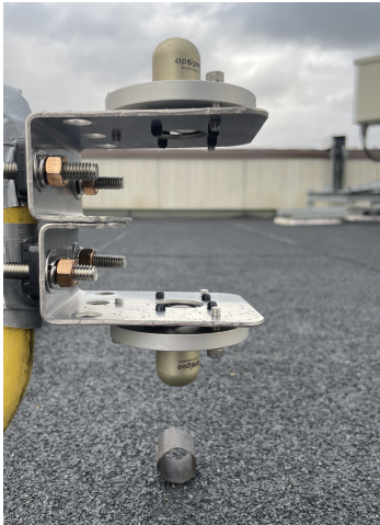
(a) To pyranometere, to AL-120 Solar Monteringsbrakett og et svart pappsylander.
