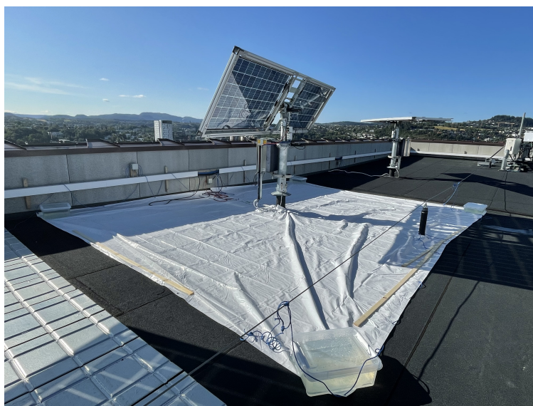
Figur 3.2: PV2 under oppsett 1. Stativet har en hvit presenning under seg som holdes nede av plastbokser med vann. I bakgrunnen er PV1 med svart underlag. Underlaget til PV3 sees i forgrunnen. Her står PV2 vendt mot sør.
