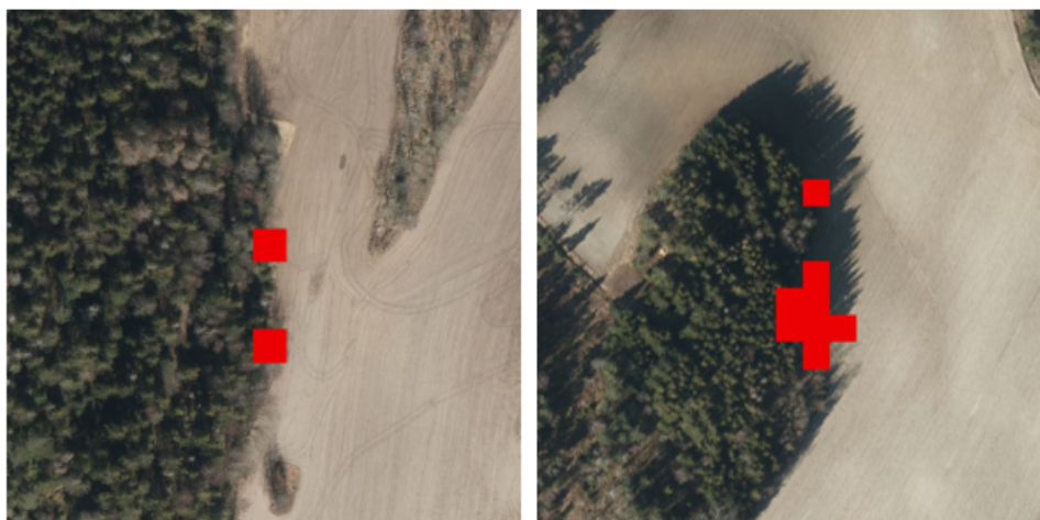
Figur 6.4: Eksempler på piksler som kan være feilklassifisert på grunn av radarskygge
