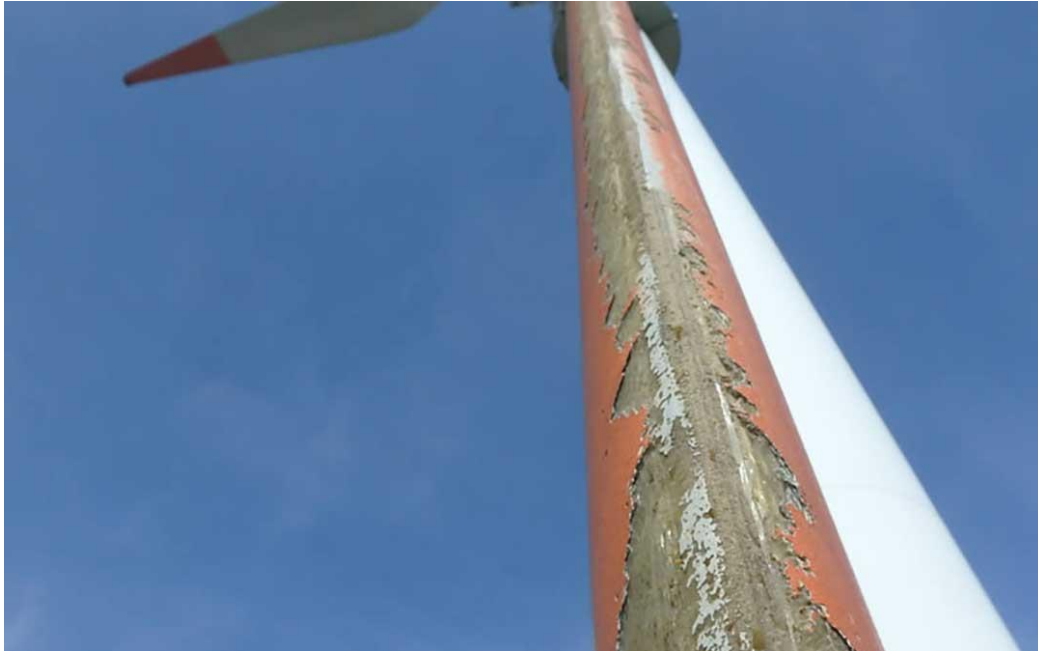
Figur 6.2: Illustrasjon av erosjon på vindturbinblad, i forkant. Dette området på bladet er spesielt belastet, og partiklene fra turbinbladet havner ute i naturen [55].
