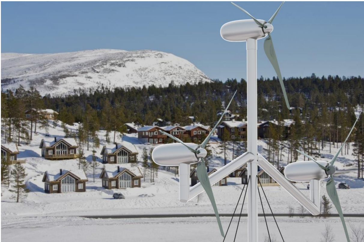
Figur 15.3: Vindturbinen med tre modul montert. Vindturbinen står i et hytteområde i fjellandskap. Fargene er tilpasset omgivelsene duse grønne turbinblader og lyst metall på tårn, stativ og nacelle.
