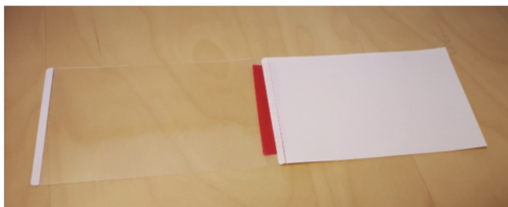
Bilde1: Plastfilmen slik den skal eksponeres. Behold tapen på i enden slik at det blir lettere å feste beskyttelsen tilbake på filmen etter endt prøvetaking.
