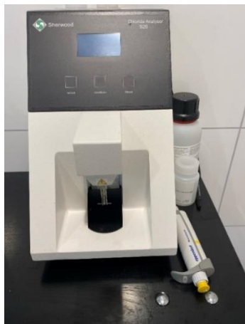
Figur 14: Utstyr for måling av klorid i plasma/serum fra Sherwood.
