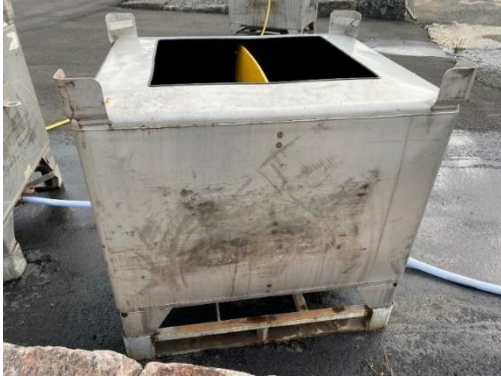
Figur 8: En av fire forsøkstanker til forsøket med skillevegg i midten.
