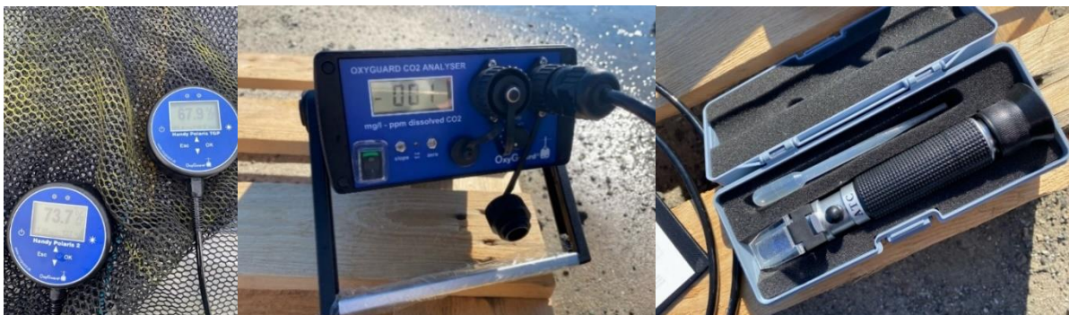
Figur 13: Handy Polaris 2, Handy Polaris TGP, OxyGuard CO 2 Analyser og Håndholdt ATC refraktometer.
