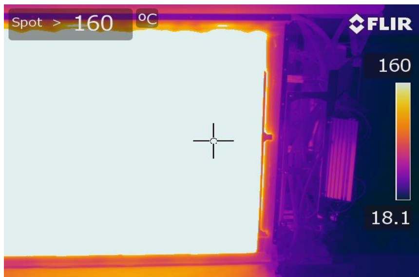
Figur 37: Viser temperaturfordelingen til ovnens varmelager, før ovnen kunne demonteres. Til høyre i bildet er temperaturskalaen, og deler av elektronikken.
