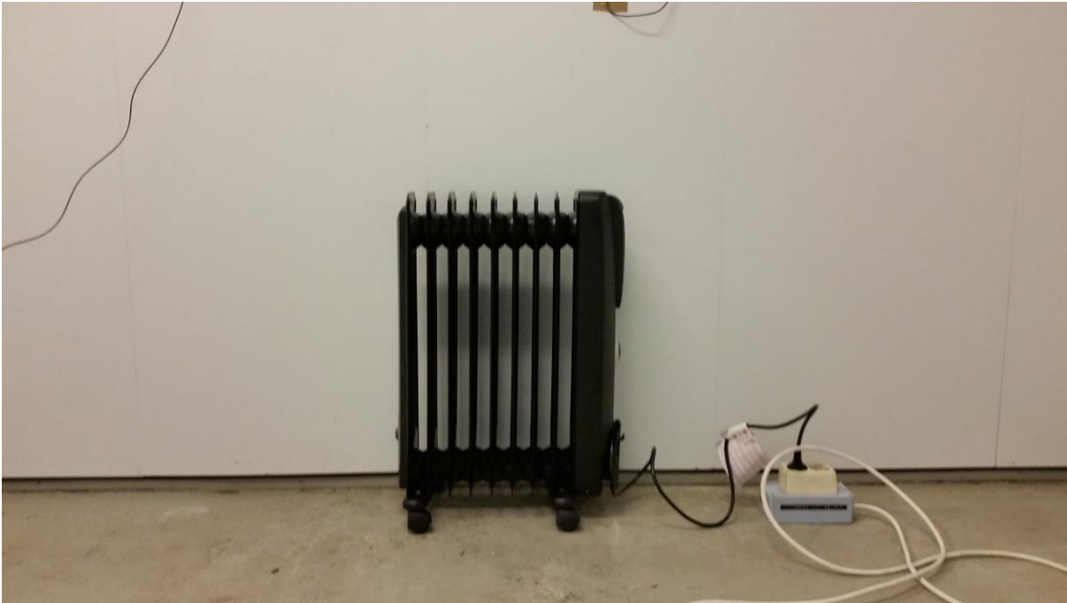
Figur 11: Oljefylt radiator i senter av forsøksrommet, plassert så nærme veggen som mulig.
