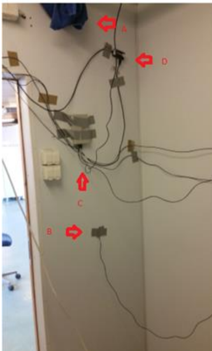
Figur 7: På bildet ser en ventilen som er tettet med et håndkle A øverst i bildet. B peker på termistoren som måler temperaturen langs veggen i nord. Alle termistorer er festet i samme høyde. C peker på den digitale analoge omformeren. Fra den går en USB-kabel gjennom en USB-forlenger D, og deretter til pc-en.
