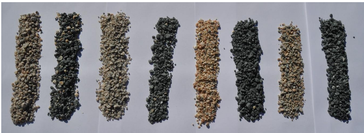
Figur 33: Steinprøvene fra boring av borehull 2, der steinprøven til venstre er fra 45 m dyp. Mot høyre øker dybden med femten meter for hver steinprøve.
