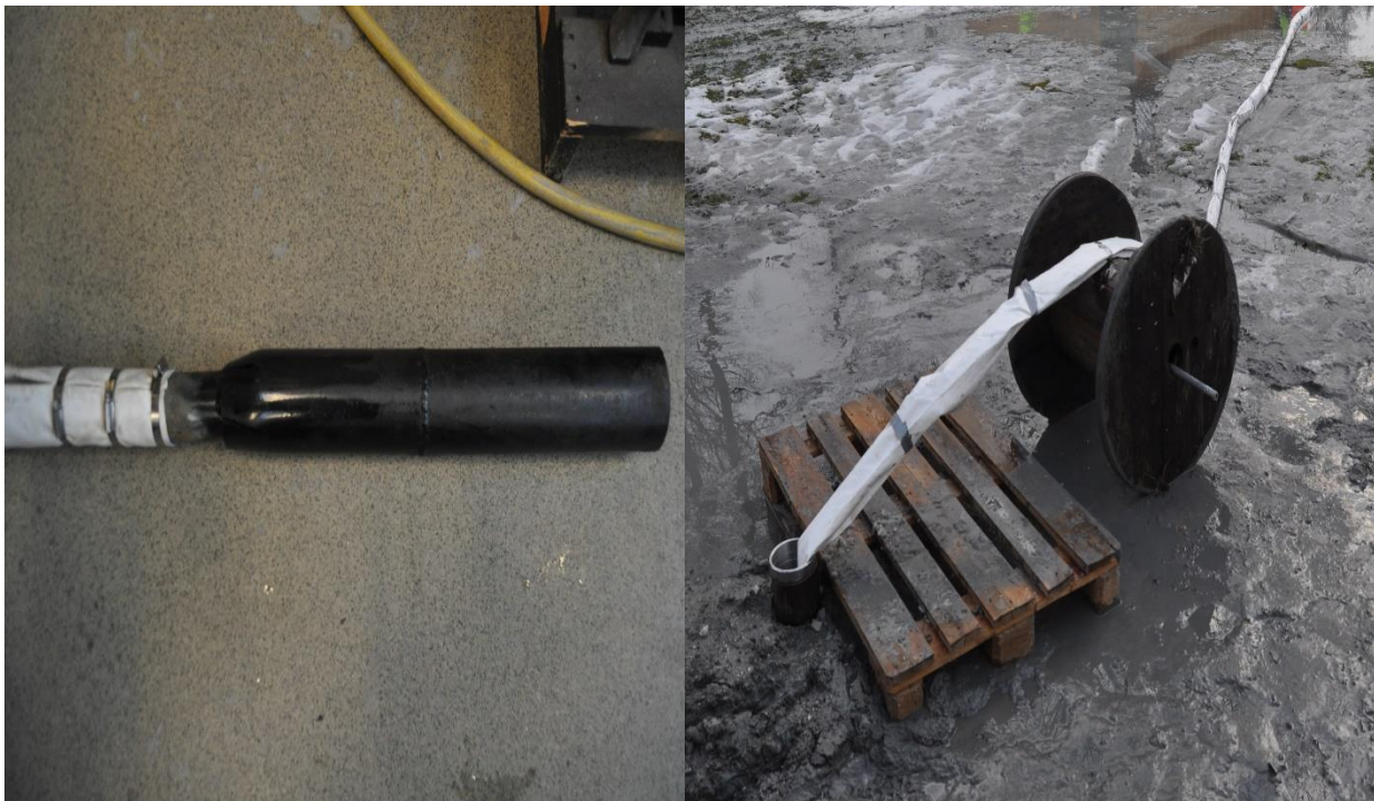
Figur 38: Bunnloddet festet til Abbakonda-kollektoren.
