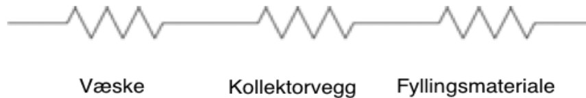
Figur 15: Borehullsmotstanden består av en seriekobling av termiske motstander mellom berggrunnen og kollektorvæsken som varmen må forplante seg gjennom (Acuña 2010).
