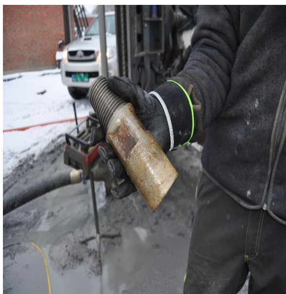
Figur 30: Tilbakeslagsventil vist fra siden.
