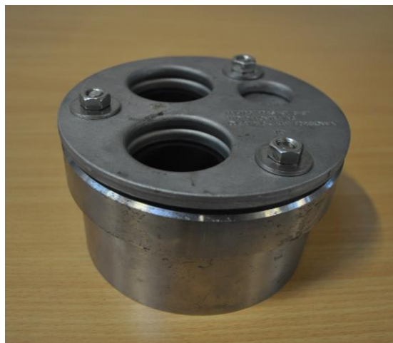
Figur 35: Kollektorlokk som ble påmontert toppen av fôringsrøret for tetting. Kollektorrørene føres ut av de to hullene.
