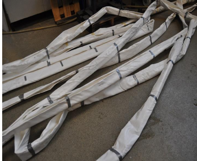
Figur 37: Abbakonda-kollektoren ble teipet sammen for hver meter.
