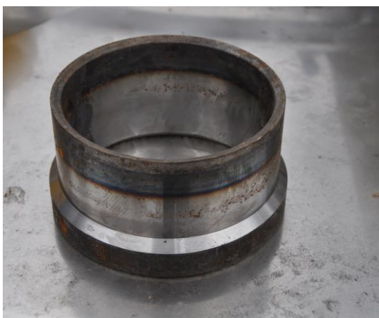
Figur 25: En borsko som sveises fast i første fôringsrør for en forsterkende effekt ved boring i løsmasser.
