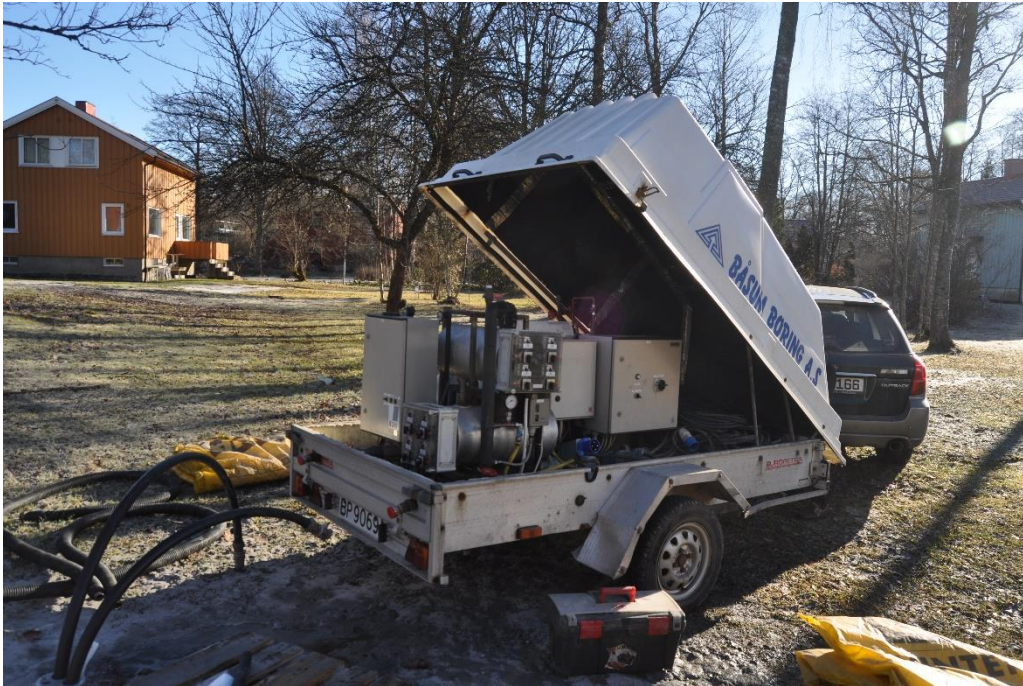
Figur 46: Testriggen brukt i forbindelse med termisk responstest. Innleid fra Båsum Boring AS.
