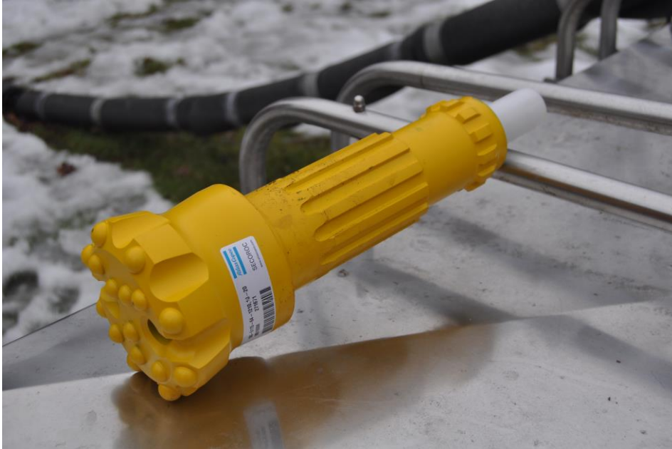
Figur 27: Flat borkrone for boring i hardt fjell. Sporene på øvre del av borkrona bestemmer maksimal rotasjonshastighet og slagfrekvens. For høy rotasjonshastighet benyttes en borkrone med mange spor.
