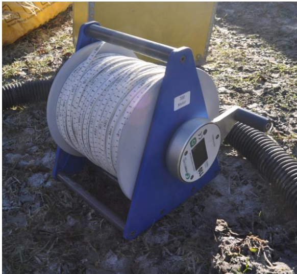
Figur 47: Sensor for måling av temperatur og vannstand.
