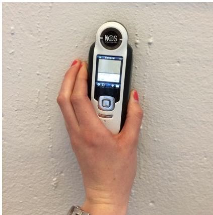
Figur 3.3.10 Fargemåleren plassert inntil en overflate
