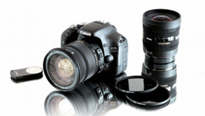
Figur 2.5.7 viser et luminanskamera. Det ser ut som et vanlig speilreflekskamera. Bildet er hentet fra technoteam.de
