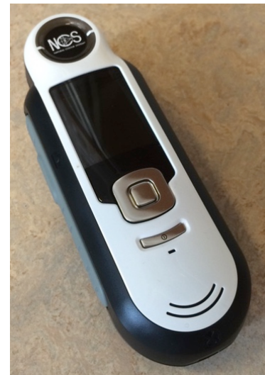
Figur 2.5.4 NCS Colour Scan 2.0 som kan brukes til å bestemme en farges NCS-kode og refleksjonsfaktor
