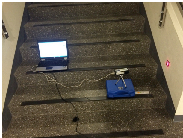
Figur 3.3.20 Datamaskinen er koblet til spektroradiometeret. Resultatene vises på
