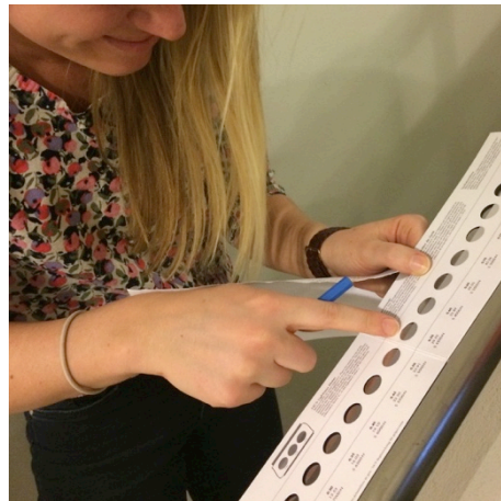
Figur 3.3.19 Måling av håndløper i stål med lyshetsmåler
