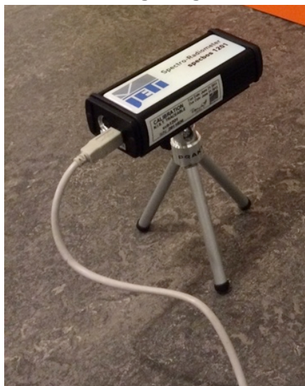
Figur 2.5.5 Bilde viser et Jeti spektroradiometer
