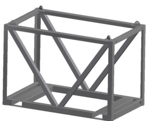
Figur 5: Forsterket løfterammen med tverrgående bjelker
