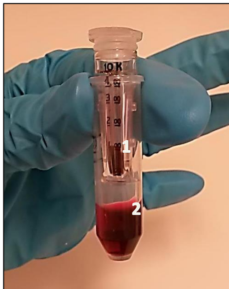
Figur 6.1.: Saft etter sterilfiltrering. Saften (2) er filtrert gjennom et filter(1) ved bruk av sentrifuge, og filteret holder igjen partikler >10.000 Da.
