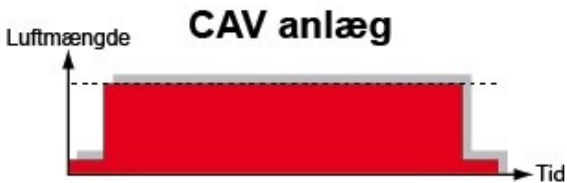
Figur 7 CAV. Kontinuerlig luftmengde. Bilde: Exhausto.no
