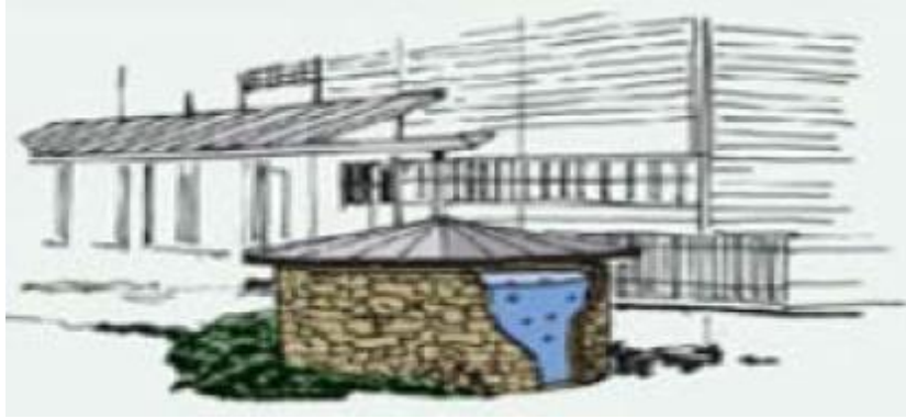
Figur 2.8.14. Figuren illustrerer en oppsamlingstank for takvann (Rossman, 2014).
