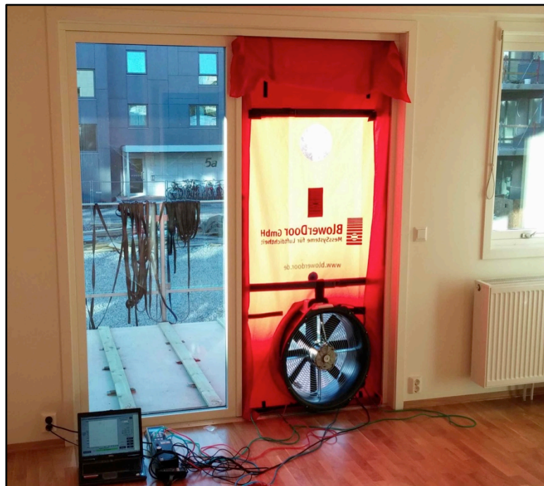
Figur 3.1 BlowerDoor koblet til PG-700 og PC med Tectite, innsatt i balkongdør (Foto: Henrik Fluge Iden)
