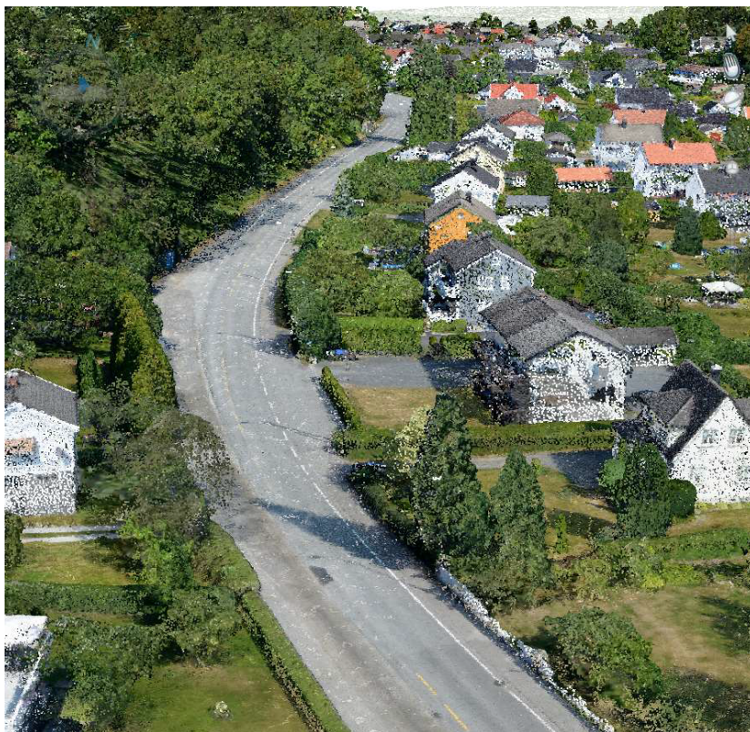
Figur 4.1: Punktsky produsert fra RGB-bilder tatt med drone. Foto: Geomatikk Survey.
