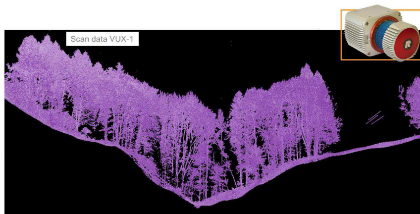
Figur 4.2: Terrengutsnitt av en terrengmodell. ©RiegI/Geomatikk Survey (med tillatelse).
