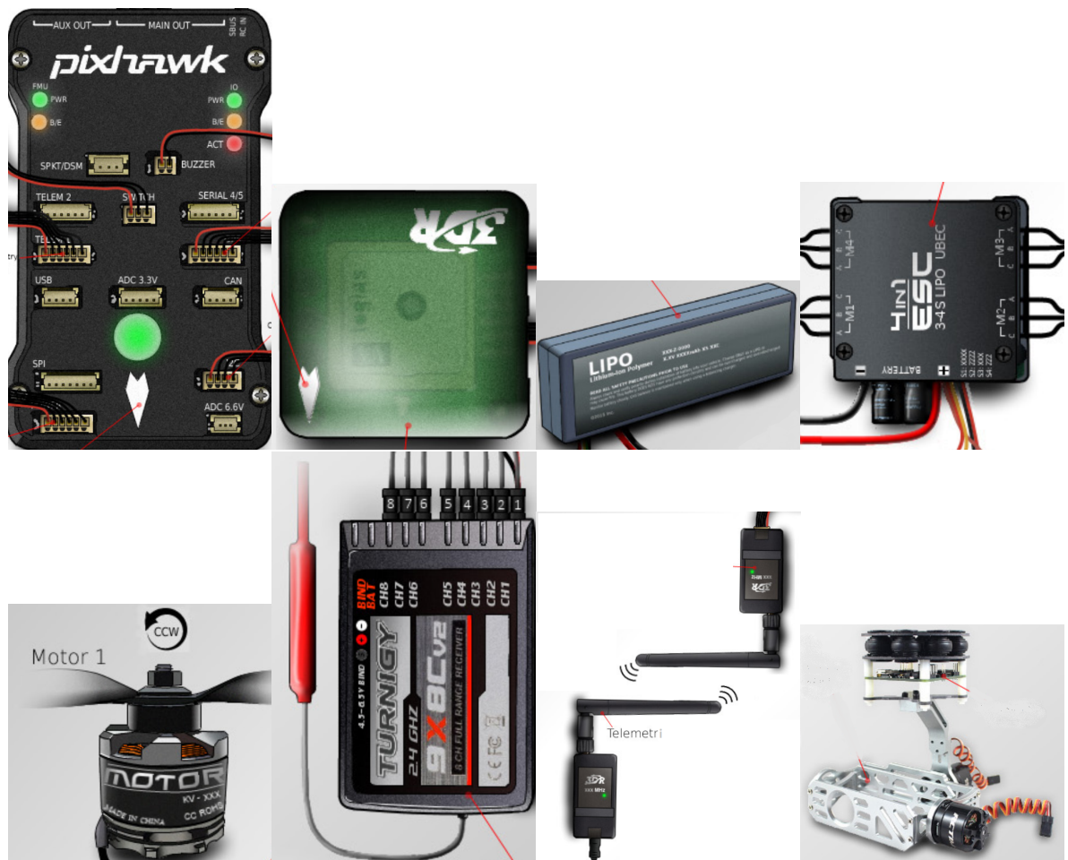
Figur 3.6: Noen av komponentene i en drone. Fra venstre mot høyre: hovedkort, GNSS-mottaker, batteri, ESC, motor, mottaker, telemetri og gimbal. Utsnitt av figuren i appendiks A.
