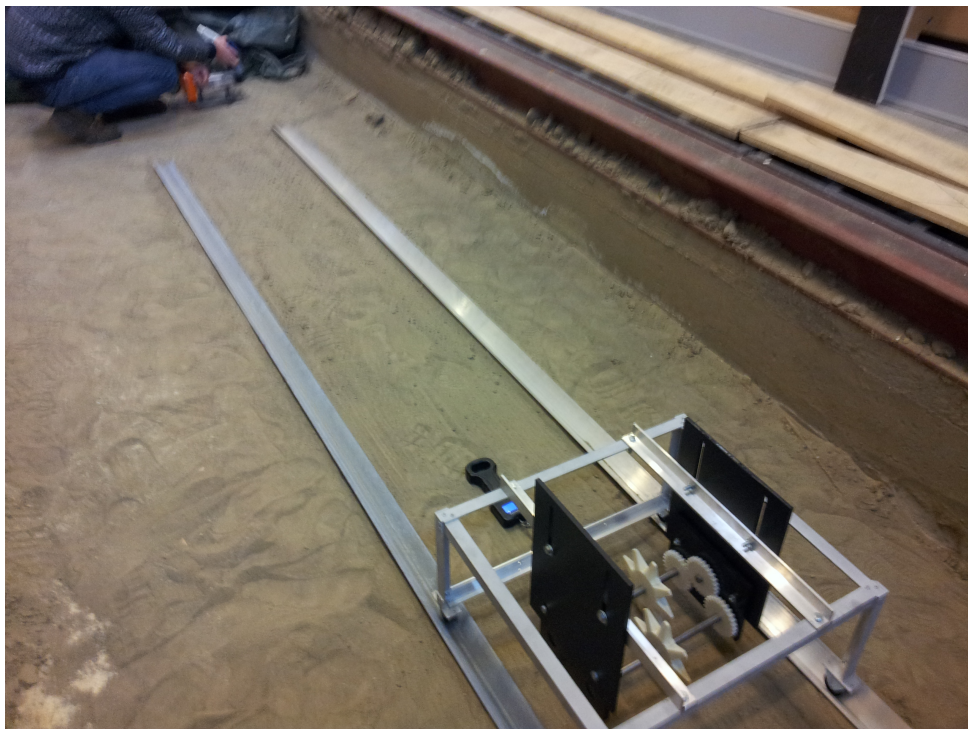
Figur 4.2: Figuren viser testtriggen vi satt opp i den gamle jordrenna på TF fløy IV ved IMT. Øverst til venstre skimtes motoren med den oransje trommelen som er koblet med fiskesene til testrammen.
