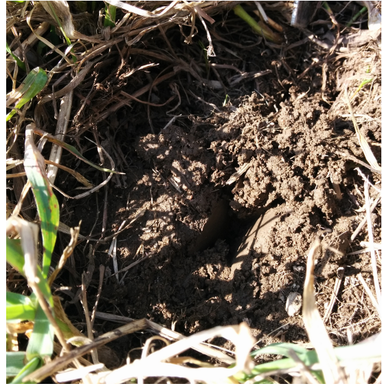
Figur 5.6: Bildet viser hullet som ble etterlatt av tannhjulspissen i det fuktige, løsere området med en vekt på 10 kg.
