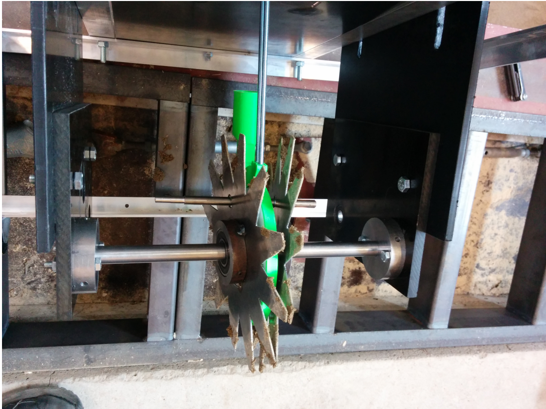
Figur 5.2: Figuren viser testprototypen av den valgte mekanismen for frøutplukking og -plassering. Utplukkercellen er plassert midt mellom de to tannhjulplatene.
