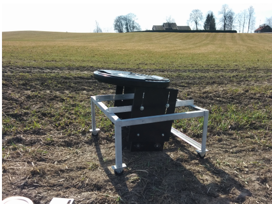
Figur 5.7: Bildet viser testoppsettet på første teststed med 20 kg plassert over verktøyopphenget.
