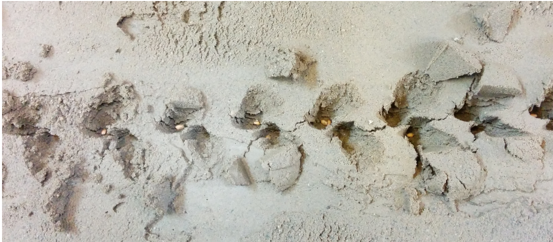
Figur 5.3: Figuren viser noen av hullene prototypen lagde i sanden, med ett korn i de fleste hullene.
