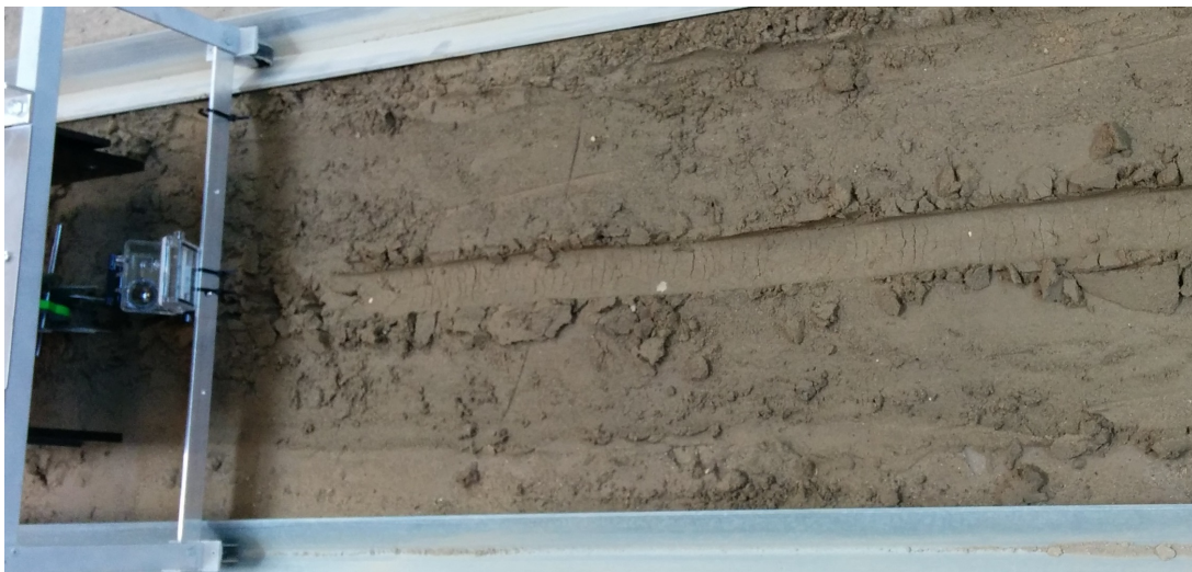
Figur 5.4: Figuren viser stripen tannhjulprototypen har kjørt over, etter en overkjøring med et enkelt følgehjul.
