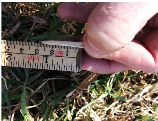
Figur 5.8: Her måles dybden av hullet som ble etterlatt ved teststed to til nært 3 cm.
