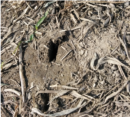
Figur 5.5: Bildet viser hullet som ble etterlatt av tannhjulspissen i det tørre, hardpakkede området med en vekt på 20 kg.
