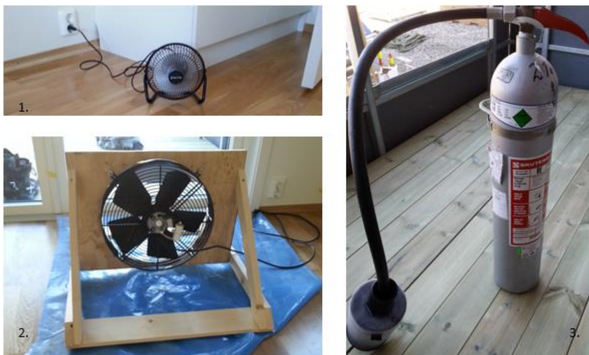
FIGUR 3-3: BENYTTET UTSTYR. 1. OTERMO VIFTE, 2. STOR EBM VIFTE, 3. CO 2 -GASS.
