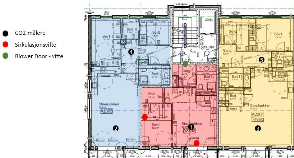
FIGUR 3-6: UTSTYRSPASSERING FOR FORSØK 1.
