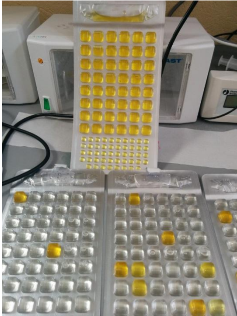
Figur 23: Resultat fra analyse av utløpsprøver (tot. koliforme bakterier).
