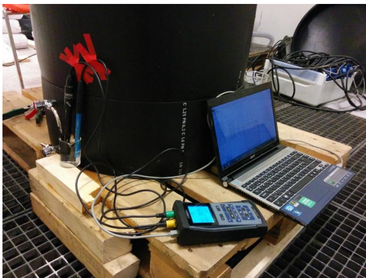
Figur 22: Oppsett ved logging av ledningsevne under tracer-test.
