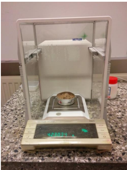
Figur 12: Veiing av sandprøve før tørking.
