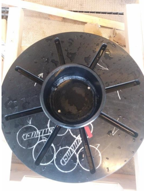
Figur 6: Fordelingsbeholderen og fordelingsplaten sett ovenfra.
