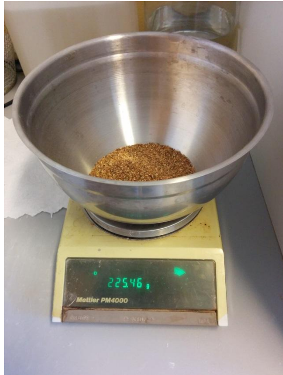
Figur 21: Vekt av korn mindre enn 2 mm og større enn 1 mm.
