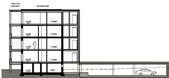
Figur 19: Snitt over tenkt løsning for påbygging og innstallering av heis i bygget, Alternativ 3. Kilde: Futurebuilt (2011c s. 4)
