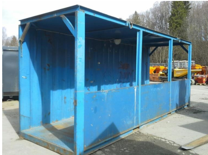
Figur 19 Eksempel på gangtunnel. Kilde: Retrade.
