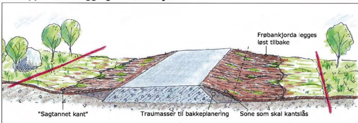
Figur 1: Skjematisk fremstilling av metoden Naturlig revegetering fra stedlig toppmasser som ble brukt ved bygging av Lofast 2. Frøbankjord ble lagret i ranker under bygging av veien og deretter lagt tilbake på den ferdige vegkanten. Figuren er hentet fra Rapporten E10 Lofotens fastlandsforbindelse – Landskapstilpasning og naturlig revegetering fra stedlige toppmasser (Kongsbakk, E. & Skrindo, A. B. 2009).
