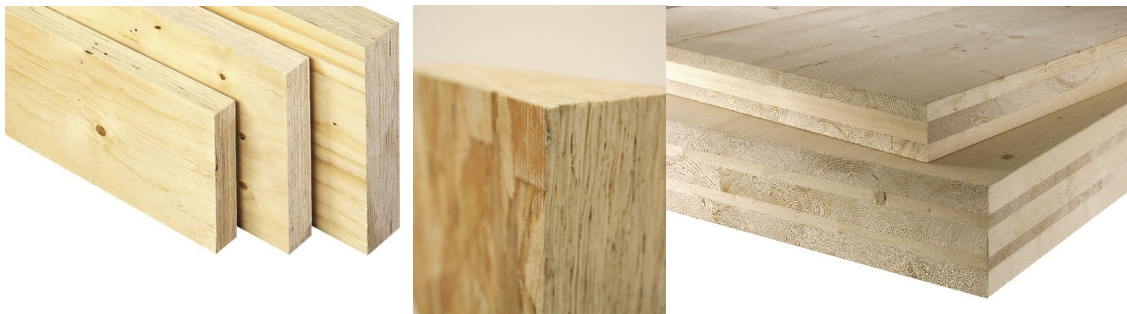
Figur 1.1 Från vänster till höger: Laminerat fanerverke, exempel på en limmad spånprodukt, massivträ. (Figur: Green, Karsh, 2012).
