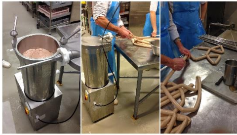
Figur 3.3: Oljetrykksprøyte/stopper med farse (venstre), etterfulgt av manuell stopping (midten) og knytting til ønsket størrelse (høyre)
