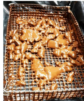
Figur 37: Klumper som oppstår i sjokolademassen. Disse klumpene fører til flere problemer senere i produksjonslinjen.
