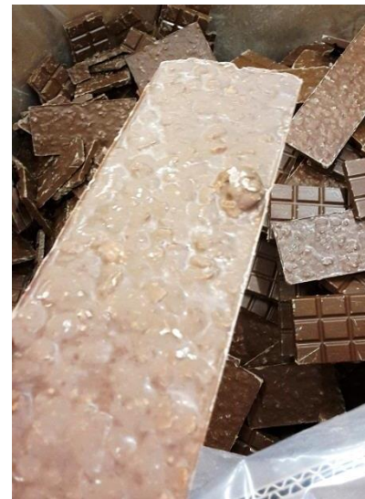
Figur 31: Når det kommer klumper i platene, fører dette til at de må kastes ut ved kontrollpostene. Hvis ikke skaper de problemer med pakkingen. Det samme gjelder for ingredienser som har festet seg sammen.
